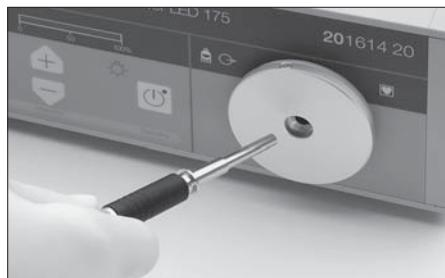
Lichtkabel bis zum Einrasten in die Buchse einschieben. In unserem Foto handelt es sich um das Lichtkabel für ein Endoskop. Lichtkabel nur am Griffstück anfassen. Niemals am Kabel ziehen.
