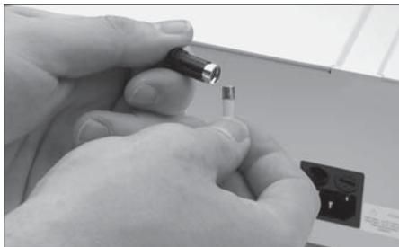
Neue Sicherungen einsetzen.
