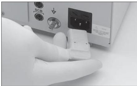
Netzkabel anschließen, Netzstecker bis zum Anschlag in Netzbuchse ⑯ des Gerätes stecken.
