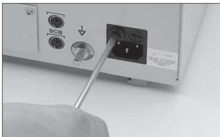
Netzsicherungshalter ⑯ mit einem schmalen Schraubendreher (Spitze ca. 6 mm breit) oder anderem geeigneten Werkzeug lösen.
