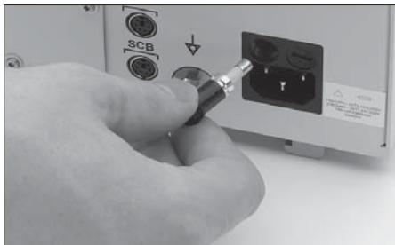
Netzsicherungshalter ⑯ wieder einsetzen.
