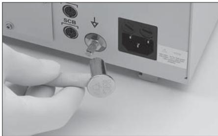
Das Gerät ist mit einer Steckvorrichtung für den Potentialausgleich ⑭ ausgerüstet. Lassen Sie die Erdung ggf. durch sachkundiges Personal durchführen.
