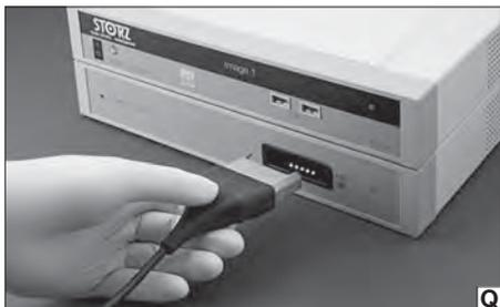
**6.11 VITOM® 3D an Lichtquelle anschließen**
