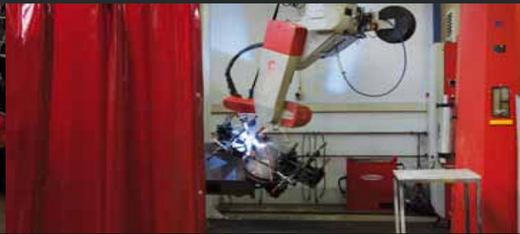
CNC-Schweißen CNC welding
